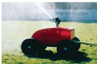
**Le Rollcart est un arroseur automat à 4 roues, 110m de câble, largeur arrosée 28 à 36 m, longueur arrosée jusqu'à 120 m.** Traveller à entrainement sur câble nylon 110m, par turbine sans rejet d'eau, arrêt automatique en fin d'enroulement. Débit 3m³/h, PS minimum 3,5 bars à l'entrée. Avancement 10 à 20 m/h. Carter ABS étanche rouge. Dimensions 0,77x0,47x0,40 m. Poids 33 kg. Raccordement tar 1'' + express.
