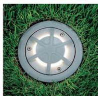
**ROMA** : Pour lampe halogène 20-35-50 W. GU10. Alimentation 230 V. Protection IP66. Isolation classe I. Corps aluminium moulé sablé. Ø 15 cm. Longueur 21,5 cm. Livré avec lampe 50 W. Câble 1,4 m. Etrier.
